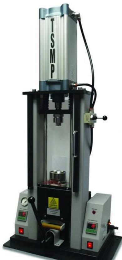
Questa pressa ad iniezione verticale è stata specificamente progettata per produrre un'ampia varietà di campioni di prova da laboratorio come placchette colore, provini per prove di trazione e di impatto nonché piccoli componenti da sottoporre a prove meccaniche.
