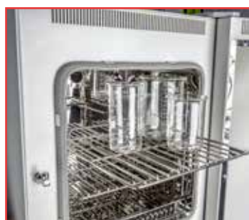
Ripiani grigliati antiribaltamento per operare sempre in sicurezza
