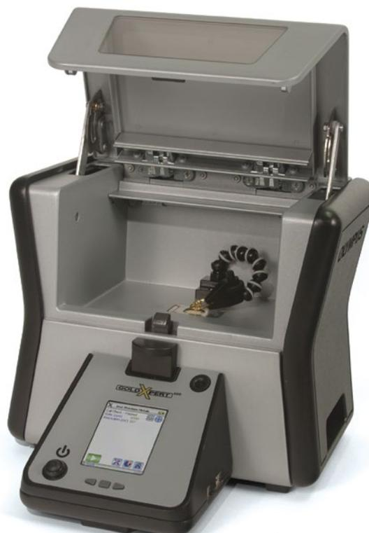
Fissare oggetti di dimensioni ridotte mediante il supporto per orientarli nella camera di analisi.
