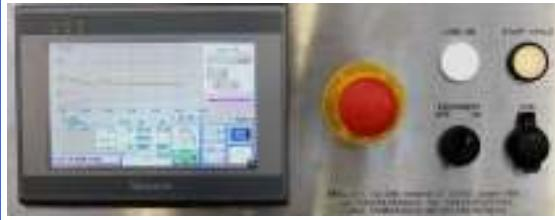
La nuova Evolution, presenta un pannello operatore multifunzionale ricco di tutte le attuali tecnologie integrate, Programmazione su doppio loop, con multi program store, registrazione grandezze termiche e climatiche multi ingresso, visualizzazione delle grandezze controllate in real time, scaricamento dati con chiavetta usb e connessione ethernet per gestione da remoto, con possibilità di controllo tramite smartphone (android o iphone)
