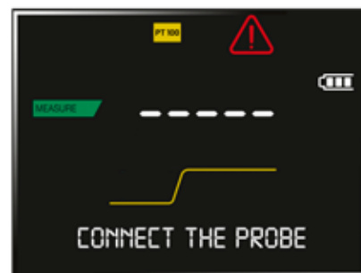
Display a colori retroilluminato e messaggi di autodiagnosi
